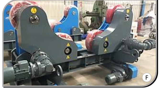
4WD-4ad.Motor+Redüktör Dişli Aktarmalı Tahrir Uygulaması
